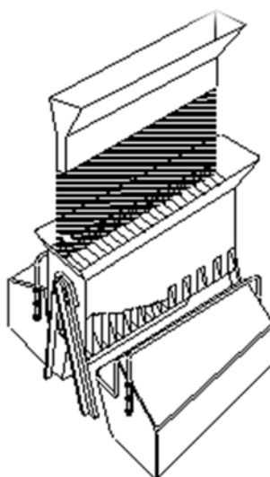
Figur 1 — Exempel på en riffelneddelare
